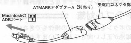
上図のように受信器のコネクタ部にATMARKアダプターAを接続することでMacintoshにセットすることができます。また、ATMARKアダプターAに付属しているフロッピーディスクの中のATMARKコントローラ用ドライバソフトをMacintoshにインストールすることで送信器の各ボタンにキーの割り付けをすることができます。
