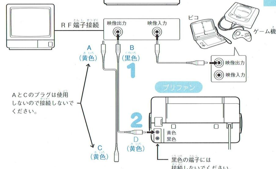
1 付属の専用ケーブルのB(黒色)のプラグをビデオ機器の映像出力端子に接続します。
