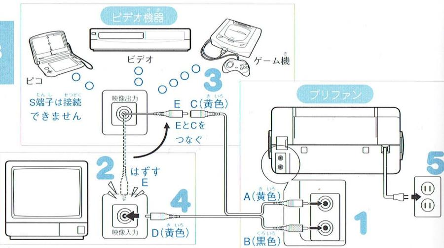
1 付属の専用ケーブルをブリファン本体後ろのビデオ端子に接続します。A(黄色)のプラグは黄色の端子に、B(黒色)のプラグは黒の端子に接続します。
