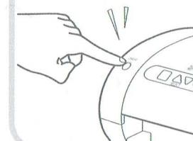
プリファン本体のインジケーター表示が回転して、インクリボンの準備をしていることを知らせます。(インクリボンの状態によっては準備に1~30秒ほどかかります)
